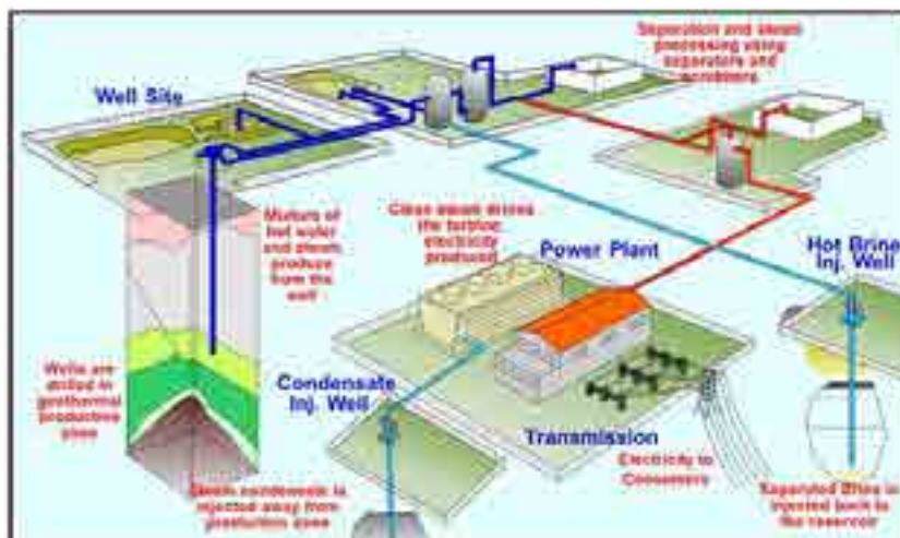
Proses pembangkitan tenaga Operasi Panas Bumi Darajat ditunjukkan pada diagram di bawah ini:
